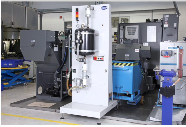
Вакуумный операционный центр VOC для создания вакуума во влажных рабочих условиях
